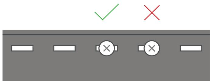
При монтаже саморез не затягивать, оставлять зазор в 1 мм, также монтаж панелей металлосайдинга осуществлять с зазорами (рисунок ниже).
